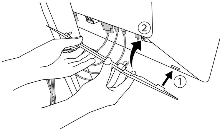
Ejemplo: Instalación de la tapa de los cables (derecha)
