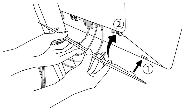
Primjer: Ugradnja pokrova kabela (desni)
