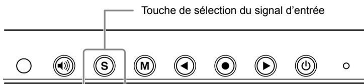
Changez le signal d'entrée en appuyant sur **(S)**. Le signal d'entrée commute chaque fois que vous appuyez sur **(S)**. Lorsque le signal est commuté, le type de signal actif (analogique ou numérique) s'affiche pendant trois secondes dans le coin supérieur droit de l'écran.
