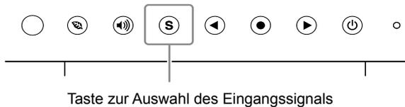
Wechseln Sie mit der Taste **(S)** das Eingangssignal. Das Eingangssignal wechselt bei jedem Drücken der Taste **(S)**. Wird das Eingangssignal gewechselt, erscheint für 3 Sekunden der aktive Signaltyp (Analog oder Digital) oben rechts im Bildschirm.
