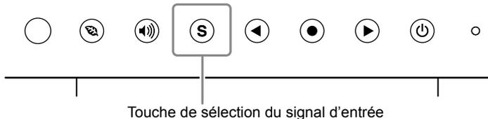
Changez le signal d'entrée en appuyant sur **(S)**. Le signal d'entrée commute chaque fois que vous appuyez sur **(S)**. Lorsque le signal est commuté, le type de signal actif (analogique ou numérique) s'affiche pendant trois secondes dans le coin supérieur droit de l'écran.
