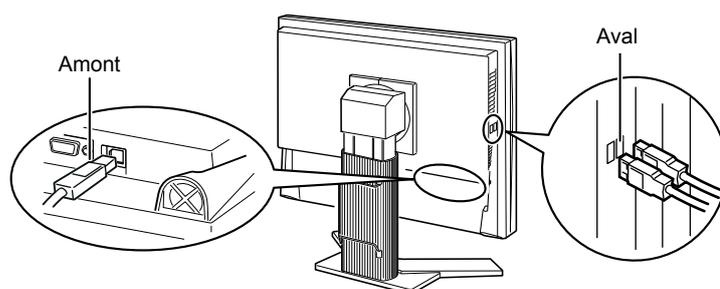
La fonction de concentrateur USB est automatiquement configurée au moment de la connexion du câble USB.
