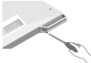
3. Schieben Sie jeden Fuß in Richtung Monitorkante und entfernen Sie die Füße wie unten dargestellt.
