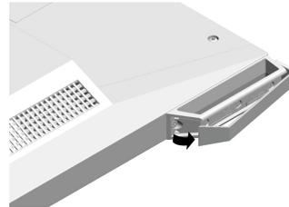
2. Entfernen Sie die Schraube, mit der jeder Fuß am Monitor befestigt ist.
