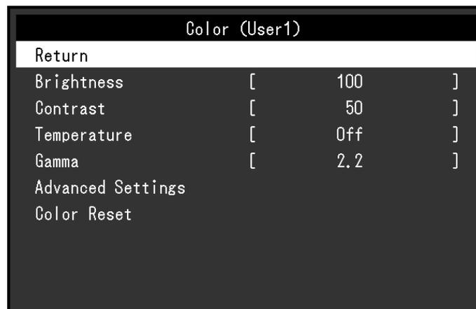
2. Wählen Sie mit ▲,▼ ein Element zum Justieren / Einstellen, und drücken Sie anschließend ENTER. Das Menü „Einstellungen / Justierung“ wird angezeigt.
