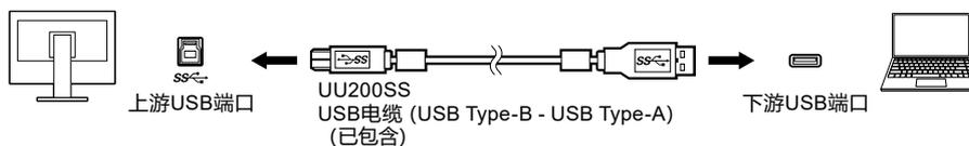
2. 请将外部USB设备连接至显示器上的下游USB端口。
