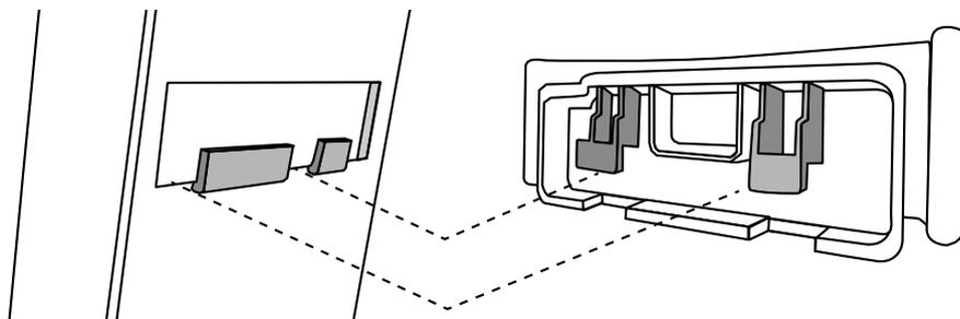
2. 将电缆固定器滑到右侧, 将其安装到底座上。
