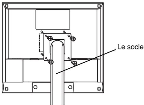
4 vis de fixation (livrées) : M4 x 12 mm
