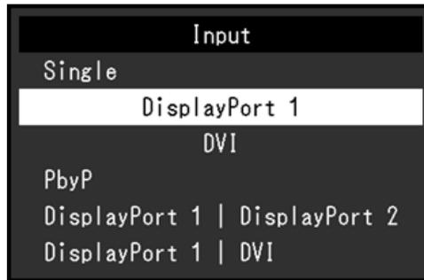
在雙重畫面模式中，在畫面左側顯示「DisplayPort 1」(D<sub>1</sub>) 輸入訊號，在右側顯示「DisplayPort 2」(D<sub>2</sub>) 或「DVI」輸入訊號。
