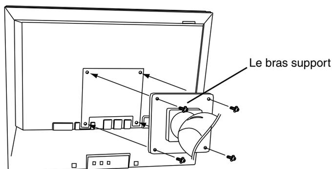
4 vis de fixation (livrées): M4 x 15 mm BZn/Fe
